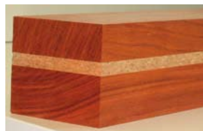
Poutre lamellée en padouk avec une couche de liège.
