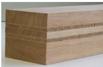
Poutre lamellée en afzelia avec deux couches de liège.
